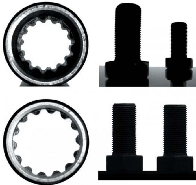
**РИС. 2.** ◀ Изображения отстоящих на разном расстоянии от объектива предметов одинакового размера и протяженного предмета, полученные с помощью обычного (сверху) и телецентрического (внизу) объектива
