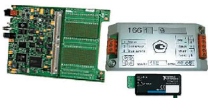
Аппаратная часть комплекса реализуется на базе оборудования National Instruments DAQPad-6015, DAQPad-6016, PXI-4472, PXI-6220, SCC-ACC01.
