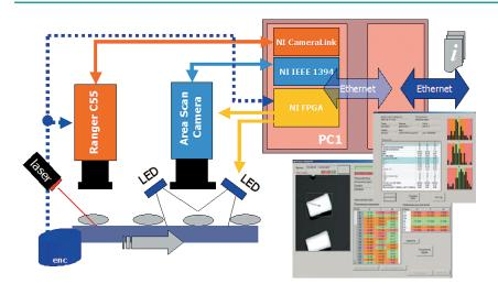
Комплекс измерения геометрии таблеток состоит из системы автоматической подачи таблеток и системы трехмерного сканирования.
