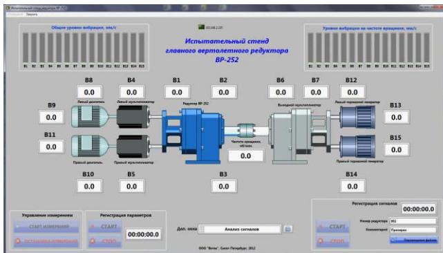
Комплекс построен на базе измерительной платформы NI PXI и обеспечивает измерение и расчет вибрационных параметров.
